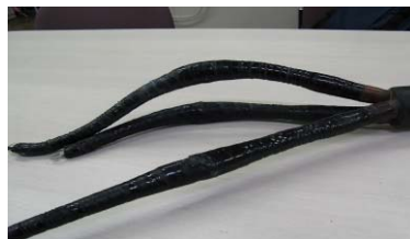
経年劣化により漏電したケーブル
