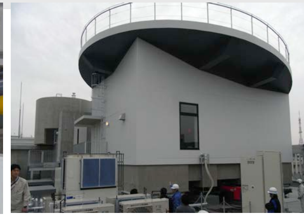
屋上・実験室：TMD装置をアクチュエータで加振し、建物全体の振動実験も可能。
